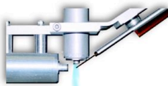
Jet freddo: condensa la frazione di analiti in colonna
